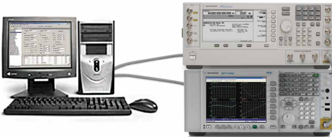
Рисунок 10 – Введение цифровых предискажений с помощью генератора сигналов серии PSG компании Agilent
